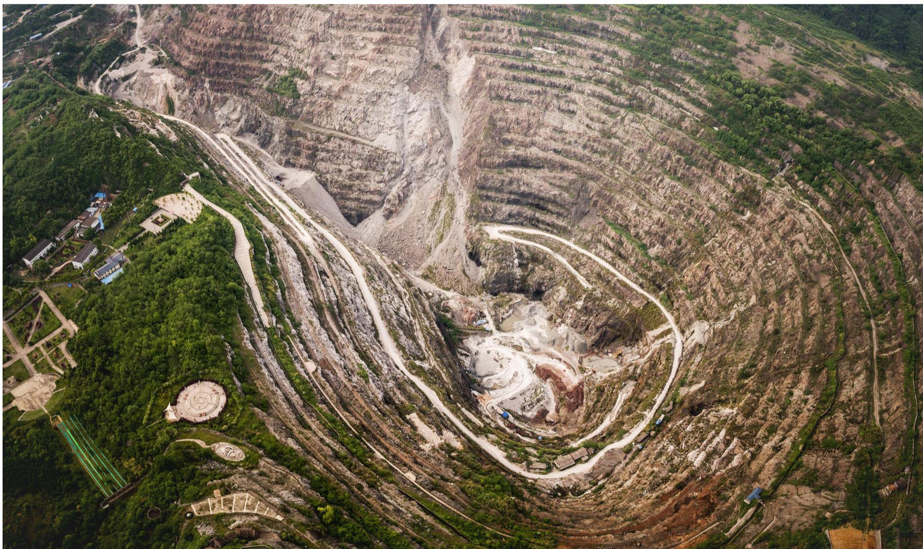
经过长年开采，矿场中已经形成一个直径超过 600 米，深度达千米的巨型矿坑，坑底溢满深绿色的积水。坑边标识显示，坑深有 1040 米。附近的山体也已经堆满了尾矿渣，高达数百米。
